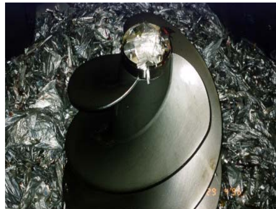
Fig 4 - Hidrapulper em alta consistência após a desagregação de fibras
