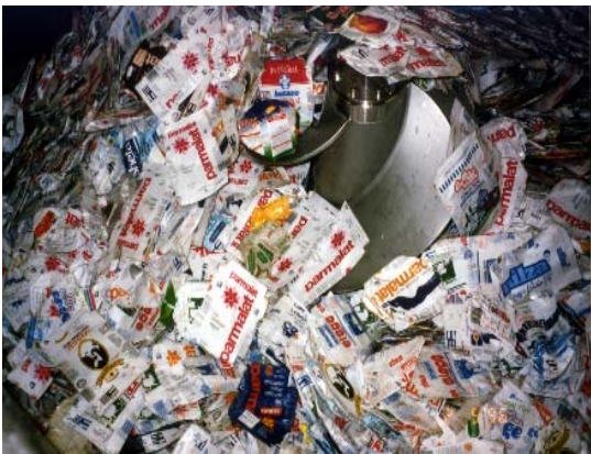
Fig 3 - Hidrapulper em alta consistência antes da desagregação de fibras
