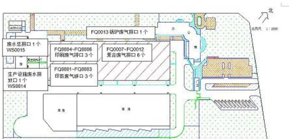
1-1 废水和废气自行监测点位示意图
