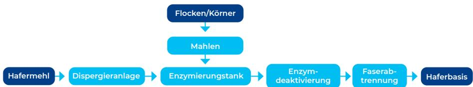
**Abbildung 2.** Überblick über den Prozess zur Herstellung der Haferbasis
