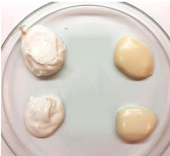
Figura 5. Muestras de queso de untar procesado tratadas con UHT en un intercambiador de calor en espiral Tetra Pak® (izquierda) y en un intercambiador de calor de superficie rascada (derecha) después de cinco meses de almacenamiento a 5 °C (muestras inferiores) y a 30 °C (muestras superiores).
