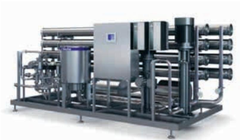
結合微濾MF、超濾UF、納濾NF和逆滲透RO膜處理技術的薄膜過濾系統適用於分餾、脫除礦物質和水的回收再利用。
